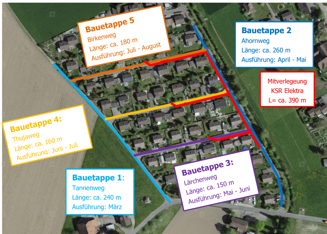
Abbildung 1: Übersicht der Bauarbeiten, Leitungsersatz Schuelhusbütz
